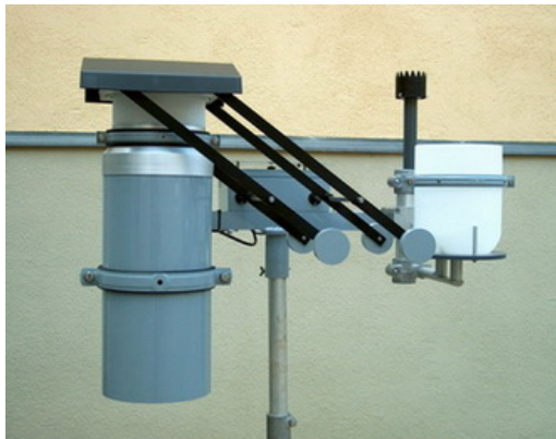
Abbildung 3: WADOS der Firma Kroneis GmbH (Messtechnik für die Umwelt-Meteorologie A-1190 Wien, Iglaseegasse 30-32). Links befindet sich die Vorrichtung zur Messung der nassen Deposition, rechts der Auffangbehälter für die trockene Deposition. Der Deckel wird je nach Witterung über die Vorrichtungen geschwenkt.
